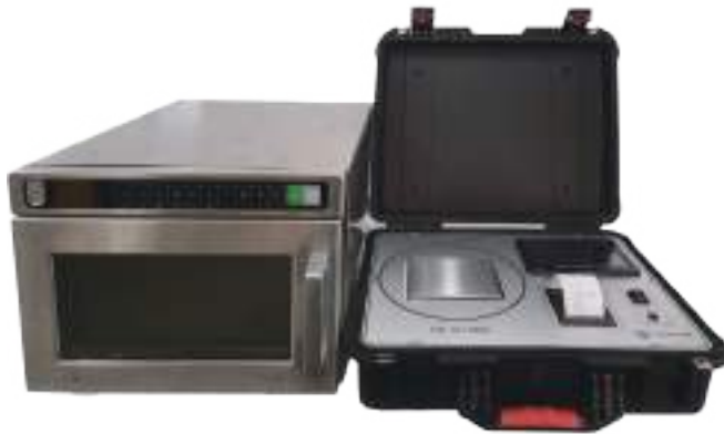
콘크리트 단위수량 측정기(DMW-2000)
